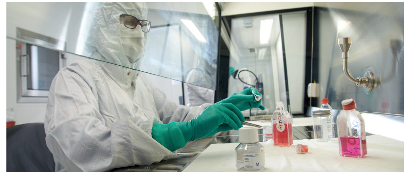
Herstellung von vorpräparierten Hornhautlamellen im Reinraum und Beladen in gebrauchsfertigem Transport-Mikroinjektor
